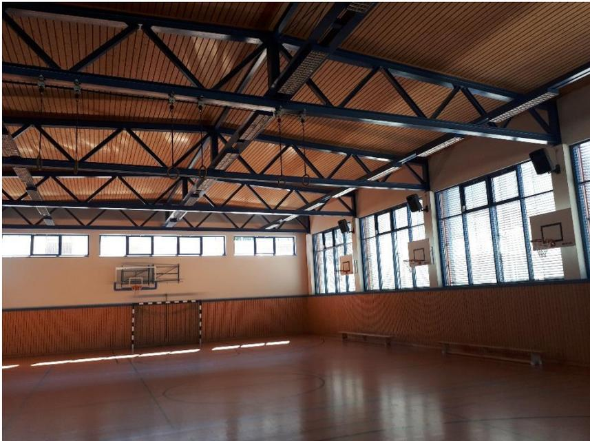
Die neue Turnhalle ist noch mit T8-Leuchtstoffröhren und konventionellen Vorschaltgeräten (KVG) bestückt. Bei Leuchtstoffröhren mit KVGs verbraucht das Vorschaltgerät zusätzlich zur Leuchtstoffröhre elektrische Energie.
