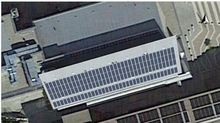
Aufgrund des großen Dachüberstandes der Dach-Nordkante wurde auf eine PV-Reihe verzichtet. Vor Umsetzung ist eine Prüfung der Statik durchzuführen.
